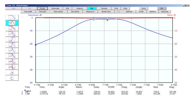
Nun erfolgt die Impedanzanpassung des Filtereingangs- und Ausgangs von 647 Ohm nach 50 Ohm. Einfach in das "Design"-Fenster zurückgehen und "Z Match" anklicken und den Eingaben folgen. Das folgende Bild zeigt nur das erste Fenster der Impedanzanpassungsroutine. Alles ist intuitiv.
