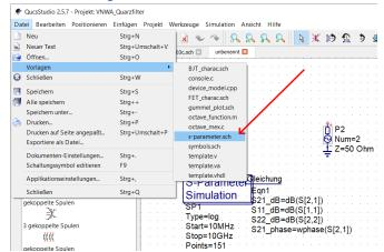
Den Schaltplan starten wir mit der Vorlage "Vorlagen-sparameter.sch" und speichern das neu geöffnete Dokument unter "quarzfilter\_3polig.sch" ab. Nun kann der Schaltplan gezeichnet werden. Das folgende Bild zeigt die von mir verwendeten Quarze und Kondensatoren. In das Bild habe ich Ausschnitte aus dem Programm gezeigt, damit die Suche nach den Bauteilen und Subcircuits leichter fällt.
