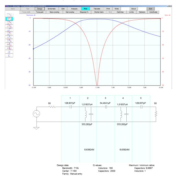
Aus dem Plot-Fenster heraus kann ein S2P-File heraus geschrieben werden. Das S2P-File kann dann an die VNWA-Software übergeben werden und enthält alle notwendigen HF-Informationen über unseren Beispiel-Bandpass. Der Button "Write S\_parameter file" anklicken und dem Elsie-Programm folgen.
