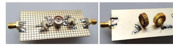
Als kleine Übung und als Ergänzung möchte ich an dieser Stelle noch eine weitere Möglichkeit vorstellen, die das intelligente und iterative Probieren ergänzen und beschleunigen kann. Mit der Time-Domain-Methode kann über eine S11 Messung in den Filter hineingemessen werden. Es wird so der Einfluss von jedem einzelnen Filterelement sichtbar. Beide Methoden der Filterabstimmung ergänzen sich.
