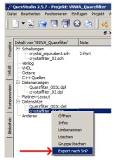
Sollen Simulationsdaten in die VNWA Software importiert werden, empfehle ich folgenden Ablauf. Zuerst werden die Simulations-S2P-Daten in die VNWA-Software importiert und nach Plot1 bis Plot4 kopiert. Anschließend wird dann die Messung des realen Quarzfilters mit anschließendem Portmatching durchgeführt.
