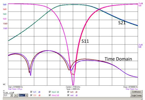
Das Bild zeigt nun die simulierten und die gemessenen Messkurven von dem hier untersuchten Bandpass. Es werden die S21, die S11 und die Time-Domain Kurven angezeigt. Für dieses Bild habe ich meinen Bandpass schon genau abgeglichen. Weitere Informationen zu den Time Domain Messungen und Einstellungen von Bandpässen entnehmt bitte der VNWA Hilfedatei in dem Kapitel "TUNING FILTERS IN TIME DOMAIN".
